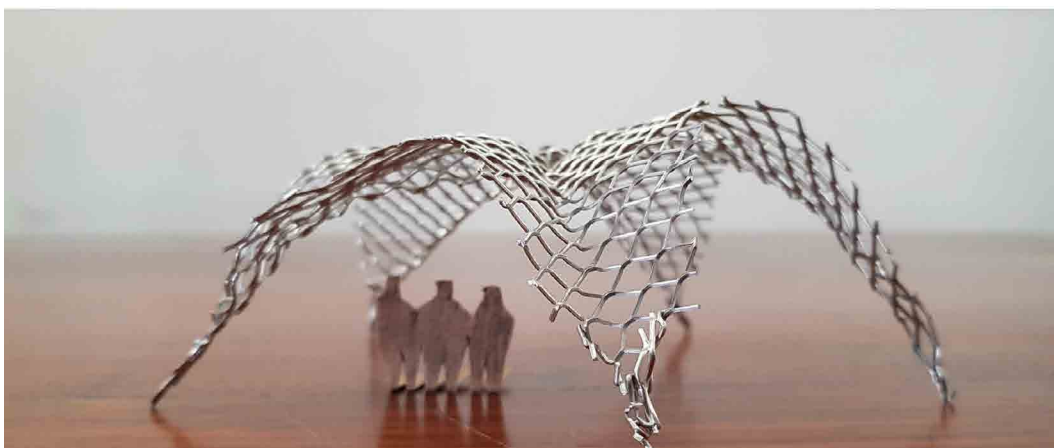
protótipo em argamassa armada, por juliana junko, larissa ferreira, maria luiza bocalini, maurício wood e pedro wendling
